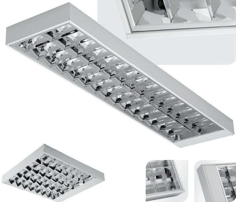
Lâmpada Fluorescente Tubular. Corpo em chapa de aço tratada e pintada. Refletor parabólico em alumínio anodizado brilhante de alta refletância e alta pureza 99,85%. Aletas parabólicas em alumínio anodizado brilhante de alta refletância e alta pureza 99,85%. Soquete tipo push-in G-13 de engate rápido, rotor de segurança em policarbonato e contatos em bronze fosforoso. Instalação de sobrepor.
