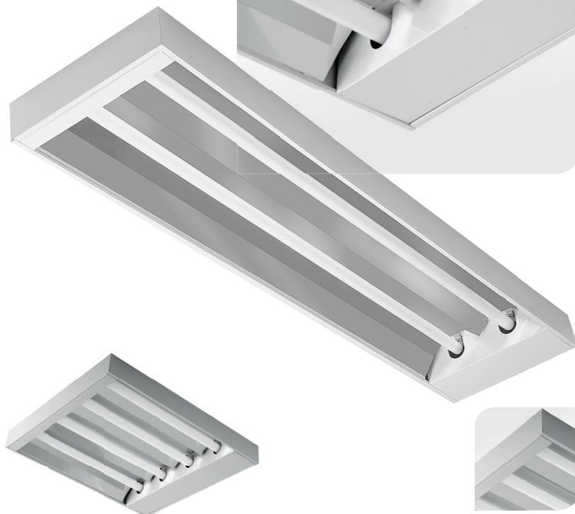
Lâmpada Fluorescente Tubular. Corpo em chapa de aço tratada e pintada. Refletor facetado em alumínio anodizado brilhante de alta refletância e alta pureza 99,85%. Soquete tipo push-in G-13 de engate rápido, rotor de segurança em policarbonato e contatos em bronze fosforoso. Instalação de sobrepor.
